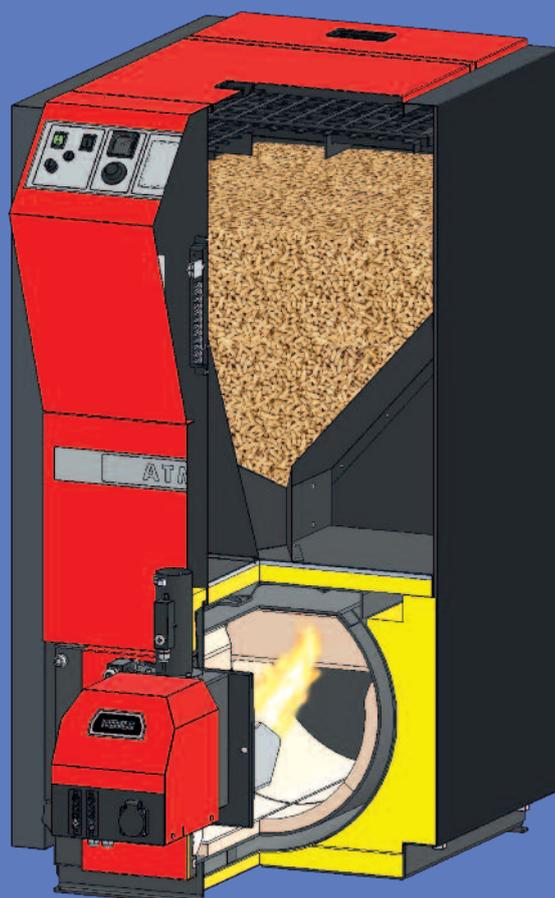
In dem oberen Bereich befindet sich ein Vorratsbehälter für Brennstoff, aus dem Pellets zum Brenner mit Hilfe eines Schneckenförderers gelangen. Die Brennstoffdosierung erfolgt vollständig automatisch.
