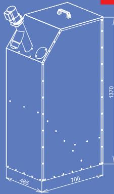
**AZPD 300** – es geht um Platzsparbehälter von 300 l Volumen. Inklusiv ist auch die Förderschnecke DRA 25 – 1,3 m. Mit einer Breite von gerademal 48 cm vergrößert sich die Stellfläche der Pelletheizung sehr gering, da es direkt an den Kessel gestellt werden kann. In diesem Behälter sind 195 kg Pellets, dh. ca 880 kWh. (13 T.)
