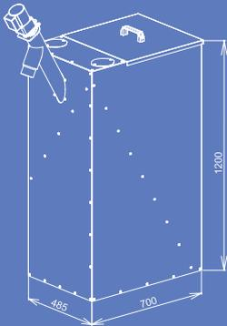
**AZPD 240** – es geht um Platzsparbehälter von 240 l Volumen. Inklusiv ist auch die Förderschnecke DRA 25 – 1,3 m. Mit einer Breite von gerademal 48 cm vergrößert sich die Stellfläche der Pelletheizung sehr gering, da es direkt an den Kessel gestellt werden kann. In diesem Behälter sind 156 kg Pellets, dh. ca 700 kWh. (10 T.)
