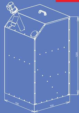
**AZPD 400** – es geht um Platzsparbehälter von 400 l Volumen. Inklusiv ist auch die Förderschnecke DRA 25 – 1,3 m. Mit einer Breite von gerademal 48 cm vergrößert sich die Stellfläche der Pelletheizung sehr gering, da es direkt an den Kessel gestellt werden kann. In diesem Behälter sind 260 kg Pellets, dh. ca 1170 kWh. (17 T.)
